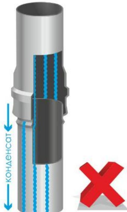
Элементы дымохода необходимо монтировать таким образом, чтобы конденсат свободно стекал вниз по внутренней стенке трубы. Стыки и соединения элементов дымохода должны быть герметичны, чтобы исключить просачивание конденсата в них или через них. Это касается и двустенных дымоходов, где попадание конденсата внутрь может привести к повреждению теплоизоляционного слоя.
