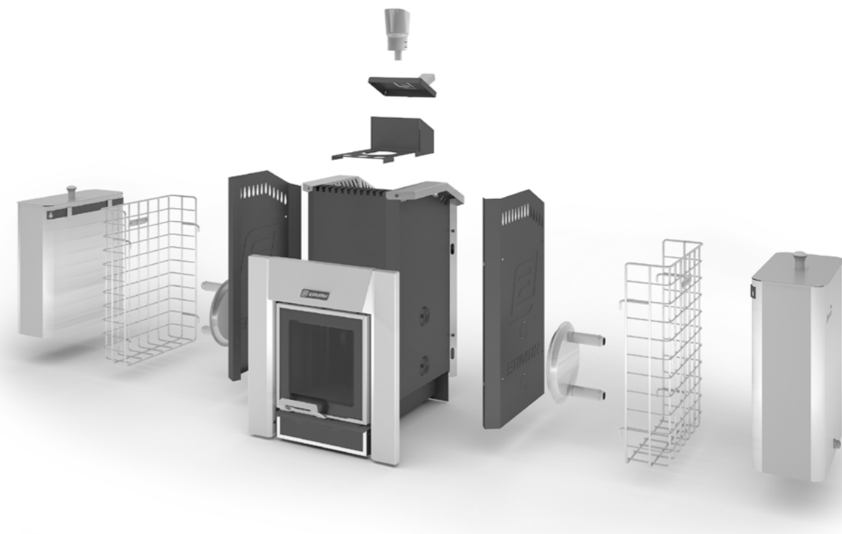
Рисунок - 1. Опции, устанавливаемые на печь
