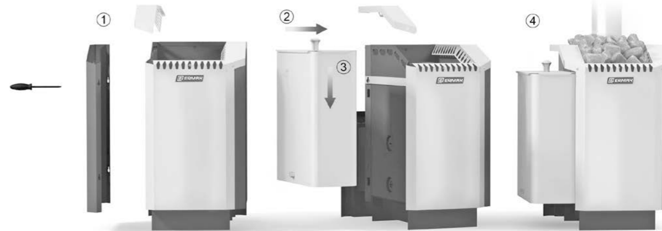
Рисунок - 8. Последовательность установки бака для нагрева воды
